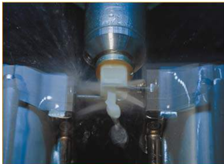
Figura 11. Detalle de la cámara de fresado del CEREC 3, con la presencia de dos fresas.
